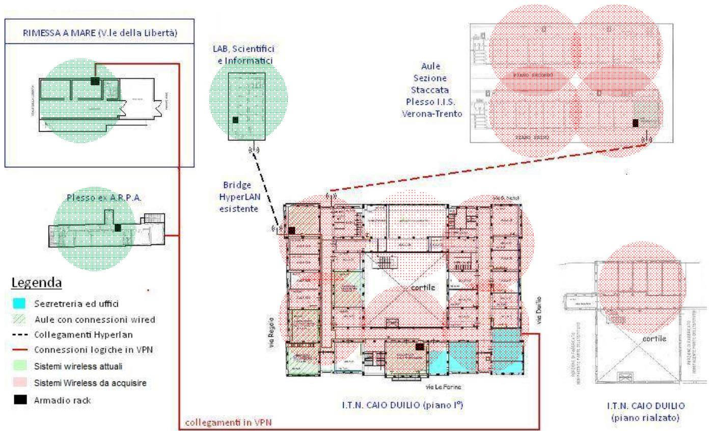
Gli armadi rack disponibili alloggeranno i dispositivi attivi di rete, costituiti da switch PoE che consentono di alimentare gli access-point, fornendo agli stessi contemporaneamente una linea wired per la connessione alla LAN di istituto.
